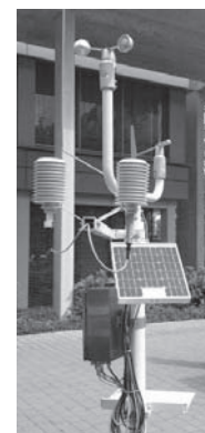
Abb. 5: Mobile Messstation des DWD mit digitaler Messwerterfassung der Lufttemperatur (in 2 m Höhe) sowie der Windrichtung und -geschwindigkeit
